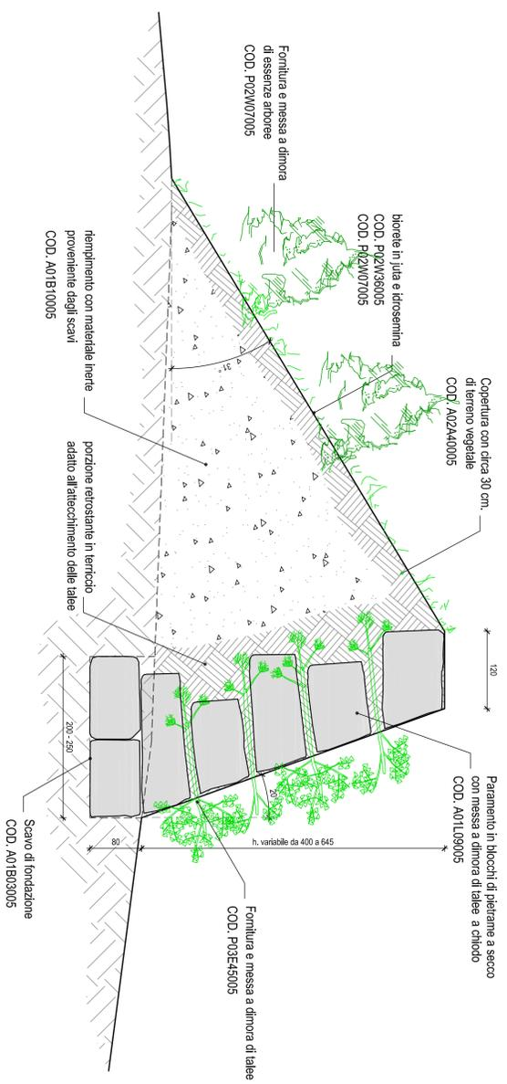
SEZIONE TIPO RILEVATO DI CONTENIMENTO
