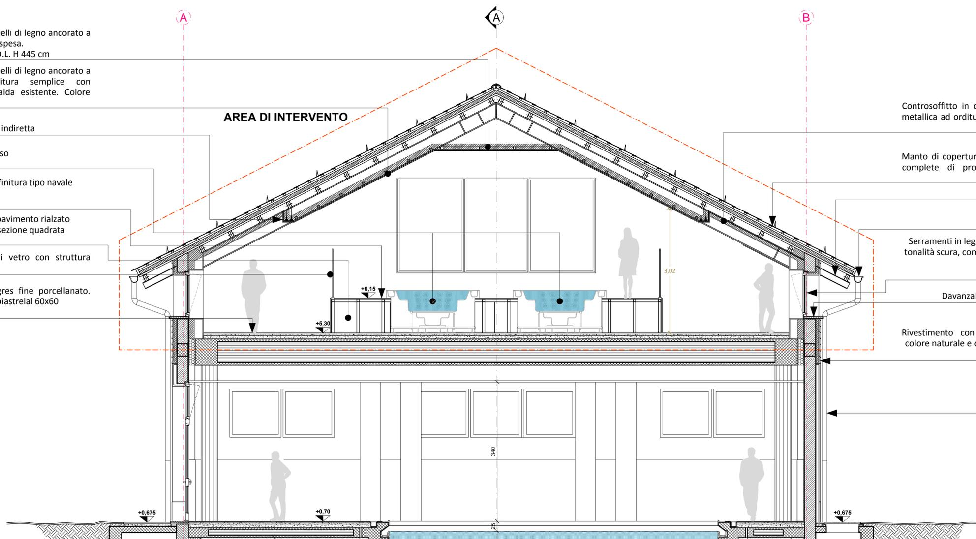
Controsoffitto in cartongesso ancorato a struttura metallica ad orditura semplice ancorata a sua volta alla copertura esistente
